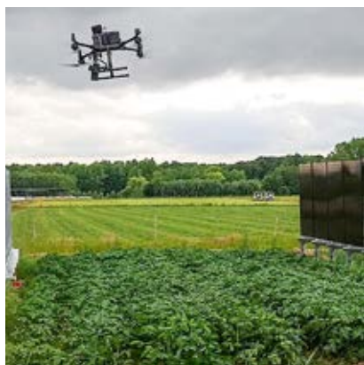
Drones maken hogeresolutiebeelden van aardappelpercelen, waarna AI-algoritmes de aanwezigheid van larven en kevers automatisch herkennen.
