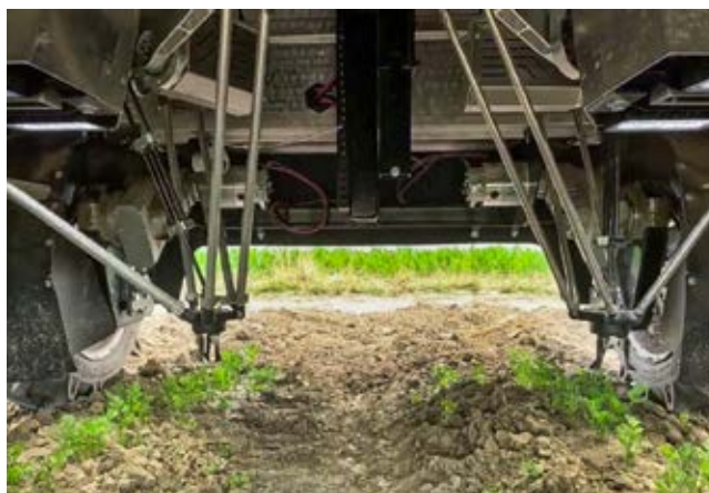
De Maverick is een autonome wiedrobot die onkruid verwijderd met behulp van beeldherkenning, artificiële intelligentie en robotgrijptjes.
