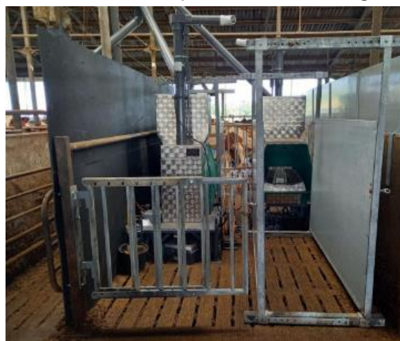
Figuur 12 De GreenFeed meet methaan in een actieve stalomgeving
