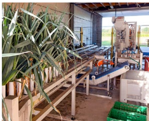
Indurra ontwikkelde een volledig geautomatiseerde oogstinstallatie die de prei zelfstandig uit de drager haalt.
