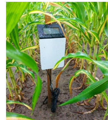
Sensoren meten de grondwaterstand en het bodemvochtgehalte.
