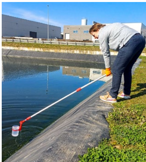
Staalname van een waterspaarbekken ter controle van de waterkwaliteit
