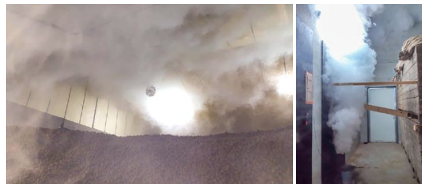
Fogging van aardappelen in een loods met 1,4Sight. Deze foto's werden genomen in 2 aardappelloodsen in 2021.
