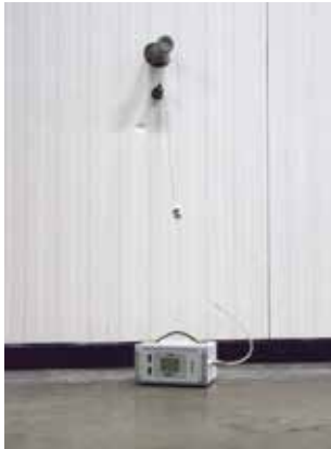
Meting van de atmosfeer via het meetpunt.
