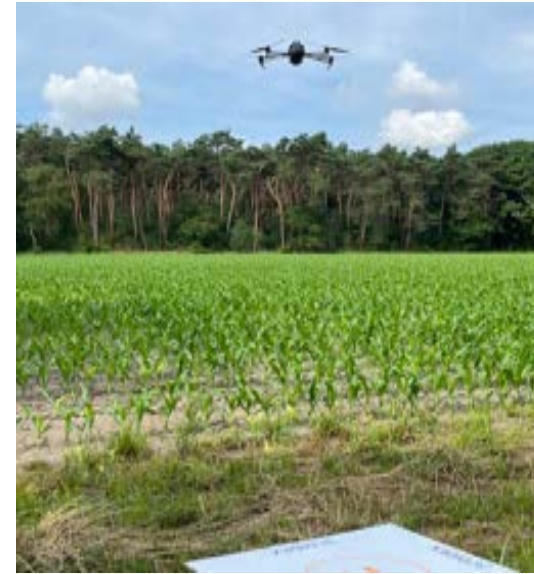
Drone sampling scan op 3,5 meter hoogte: mm resolutie
