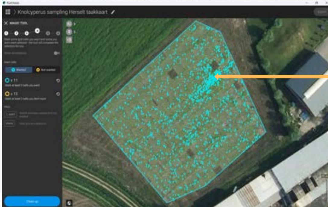
Drone sampling scan op 3,5 meter hoogte: mm resolutie
